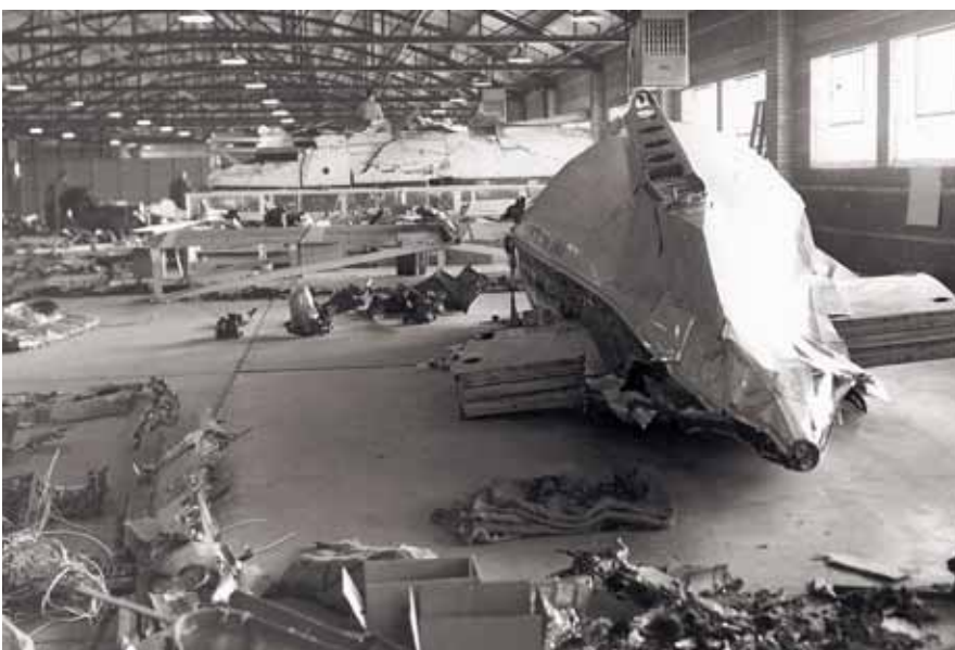
Minutiös hatten die FBI-Agenten die Puzzleteile der explodierten Maschine in der Halle wieder auf einem Drahtgestell zusammengebaut.
